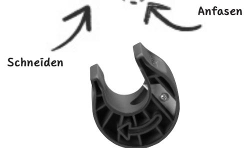
**B** Schneide die Rohre gemäß Plan auf die richtige Länge zu. Achte darauf, dass keine Erde in die Rohrleitung gerät. Falls erforderlich, fase das Rohr an, d.h. entferne unsaubere Schnittkanten. Für gerade Rohr-Schnitte in nur einer Umdrehung, verwende das GARDENA Schneidwerkzeug für Verlegerohr (Art.-Nr. 2727).
