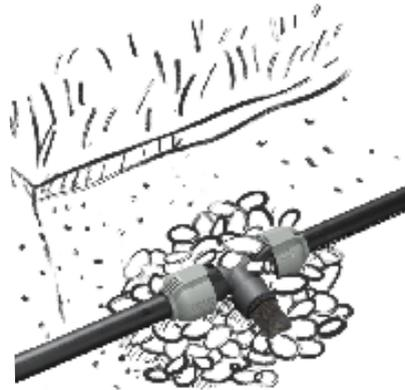
**G** Jetzt platzierst Du die Leitungen mit Anlussteilen und Regnern im Graben. Alle Regner und Düsen müssen bündig zur Erdoberfläche installiert werden. Der Düsenkopf inklusive Griffmulden sollte sich zur regelmäßigen Reinigung oberhalb der Erdoberfläche befinden.
