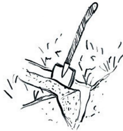
**F** Steche mit einem Spaten ca. 20–25 cm tiefe v-förmige Leitungsgräben aus. Nimm dazu vorsichtig die ausgestochene Grasnarbe ab und hebe den Graben aus. Entferne die Steine aus dem Graben.
