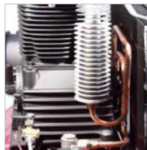
Kühler aus Alu- Druckguss und Kupferkühlleitung
