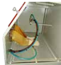
PAL Innenraum (Injektorsystem)
