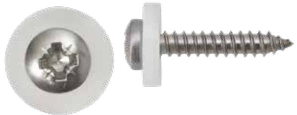
Zur Befestigung von Fensterbänken an Aluminium-, Holz- und Kunststoffenstern Verarbeitungshinweis: Bitte beachten Sie, dass in gerbsäurehaltigen Hölzern (z. B. Eiche) der Einsatz von Schrauben aus martensitischem Edelstahl bzw. Edelstahl A2 nicht zu empfehlen ist.
