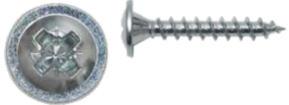
Die Rückwandschrauben eignen sich besonders zur Befestigung von dünnen Hartfaserplatten oder Furnierholzplatten an z. B. Schrankrückwänden oder Regalen. Der flache Linsensenkopf hat eine besonders große Auflagefläche, wodurch eine Beschädigung der dünnen Rückwand ausgeschlossen wird. In Feuchträumen und im Freien sind geeignete Werkstoffe bzw. Oberflächenbeschichtungen zu verwenden, wie z. B. Verbindungsmittel aus nichtrostenden Stählen oder feuerverzinkte Verbindungsmittel. (DIN 18360:2019-09).
