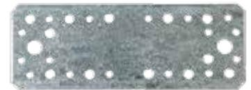
Flachverbinder sind vielseitig einsetzbar. Sie können sowohl Druck- und Zugkräfte übertragen, sofern der Kraftangriff mittig erfolgt, als auch abhebende Kräfte aufnehmen. Sie sind für Verbindungen von Holz an Holz und Holz an Beton geeignet. Vorrangig werden sie für die Verbindung von Pfosten an Balken und zur Lagesicherung verwendet.
