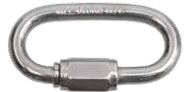
Kettenschnellverschlüsse werden zur einfachen Verbindung und Verlängerung von Ketten verwendet. Ebenso sind sie einsetzbar für das Verlängern von Karabinerhaken und das Befestigen an Ringen. Sie sind nicht für das Heben von Lasten geeignet. Höchste Korrosionsbeständigkeit
