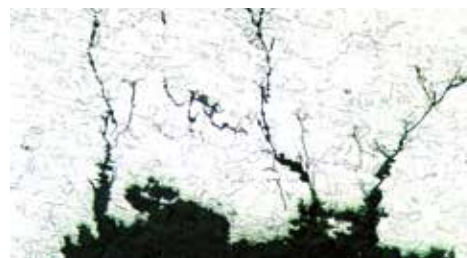
Beispiel für transkristalline Spannungsrissskorrosion an 1.4401 bei starker Chloridbelastung
